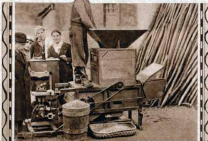
La meccanica fa progressi anche nel campo della castagnicoltura. Ecco una macchina sgusciatrice che sostituisce il sacco per la picchiatura, la pestatura, i cestoni, il vassoio, gli zoccoli, ecc., e soprattutto fa risparmiare tempo ed evita il lavoro lungo e faticosissimo richiesto dalla sbucciatura delle castagne eseguita a mano
